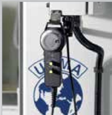
Elektronisches Handrad für eine präzise Positionierung der gewählten Achse. Electronic hand- wheel for the manual accurate positioning of the selected axis.
